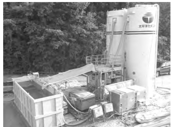
写真 3 固化材のスラリープラント (24m 3 /hr.型)
