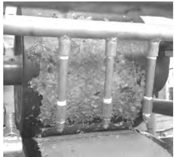
図 10 固液分離ドラムから回収用ドラムへの転写の様子
