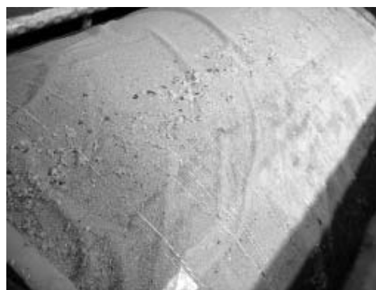
図 3 固液分離時のドラム表面 (大型試験機)
