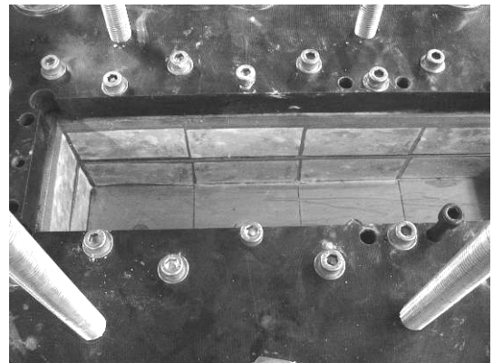
写真2 せん断箱部分(側面部分に摩擦軽減層)
