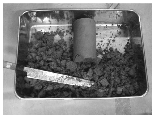
写真4 初期固化土の解砕
