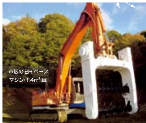
DAMの攪拌混合部
