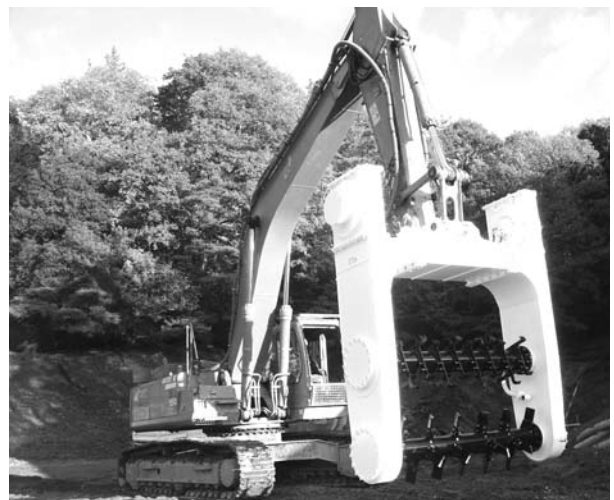
写真1 DAMの攪拌混合部
