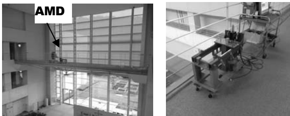
図 12(b) 渡り廊下での制御実験風景
