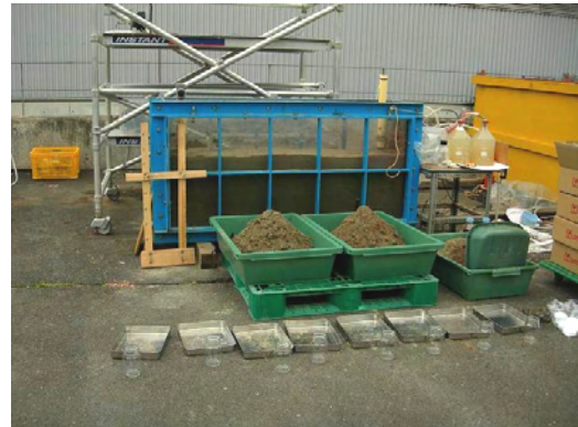
図7 供試土回収状況
