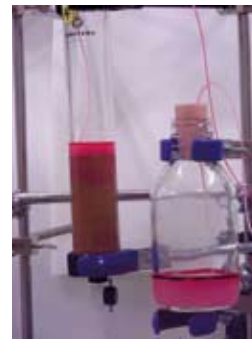
油の回収状況 右:軽油汚染標準砂カラム 左:廃液瓶
