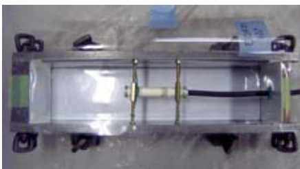
写真1 自己収縮ひずみ測定 (10×10×40cm)
