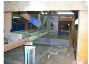
写真 2 Fc36 の漏れと打設間隔 90 分での引抜き状況
