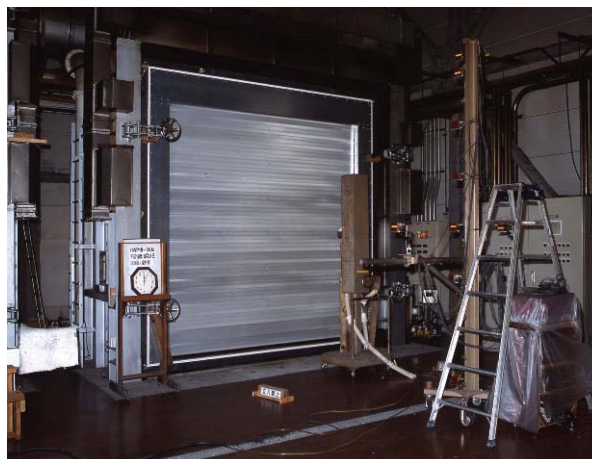
写真5. 性能評価機関による耐火性能評価試験
