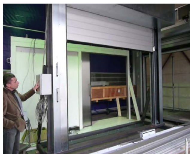
写真4. 高速開閉耐久試験中のアルミ防火シャッター
