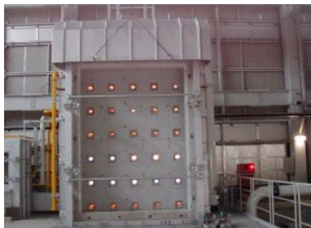
写真1. 大型壁式耐火試験装置
