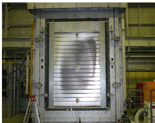
写真3. 遮炎性能試験中のアルミシャッター
