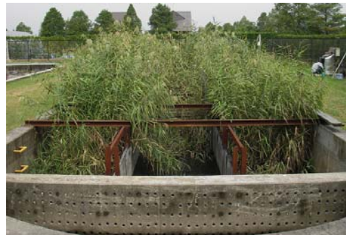
写真5 改良土からのヨシの生育状況 (左から3列順に、改良土 q_c=500\text{kN/m}^2 、川砂、改良土 q_c=800\text{kN/m}^2 )
