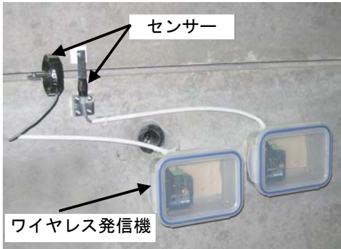
写真3 ワイヤレスセンサ設置状況
