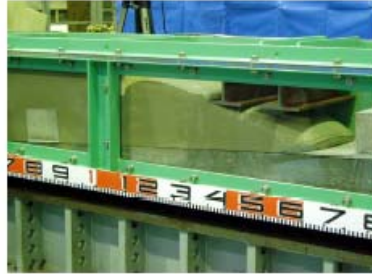
(b)H型鋼周辺の注入状況
