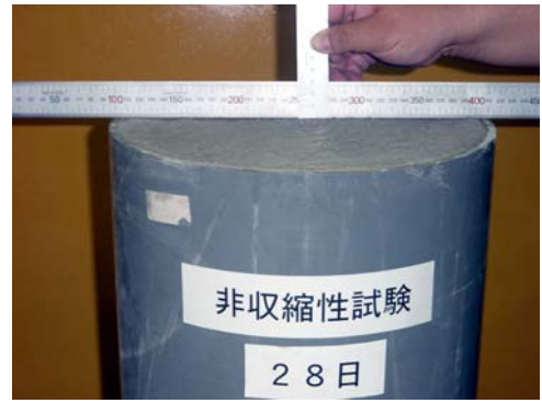
図6 非収縮性試験状況
