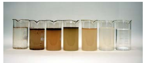
図8 経時サンプル採取状況 左端:洗浄開始～ 右端:浄化完了
