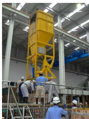
コンクリート打設状況および実大有筋試験体（夏期実大施工実験）
