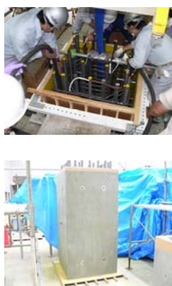
コンクリート打設状況および実大有筋試験体（夏期実大施工実験）
