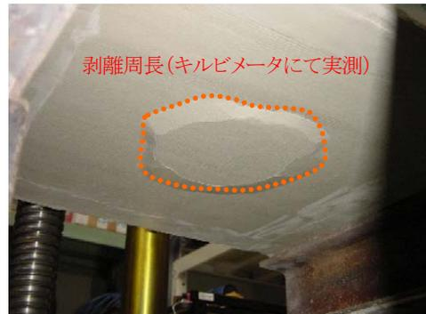
図5 押し抜き試験のイメージと剥離状況
