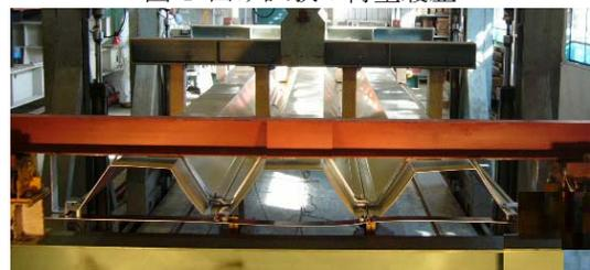
写真 1 曲げ試験体 M8-1 試験体幅 1.5m(3 山)
