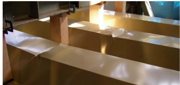
写真 4 折板の局部座屈状況 M8-M-1
