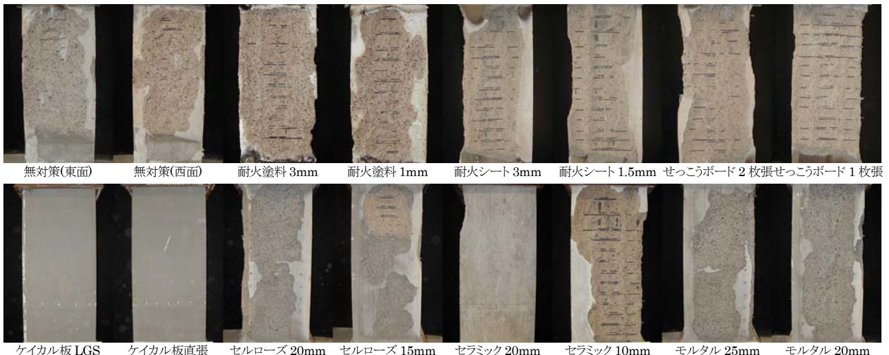
写真 1 加熱終了後の試験体の状況(実験 1)
