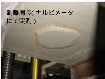
図 2 押し抜き試験のイメージと剥離状況
