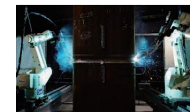
溶接用ロボットによる鋼管柱の溶接状況
