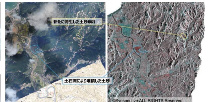
2024年9月能登半島豪雨前後で撮像した小型SAR衛星StriXのデータを利用した解析例
