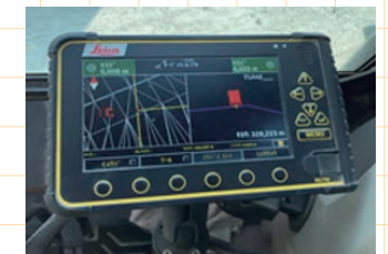
ブルドーザー誘導測量システム
