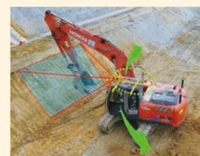
重機の屋根にレーザーキャナを取り付け、重機を回転させて法面などの出来形を3次元で計測することができる
