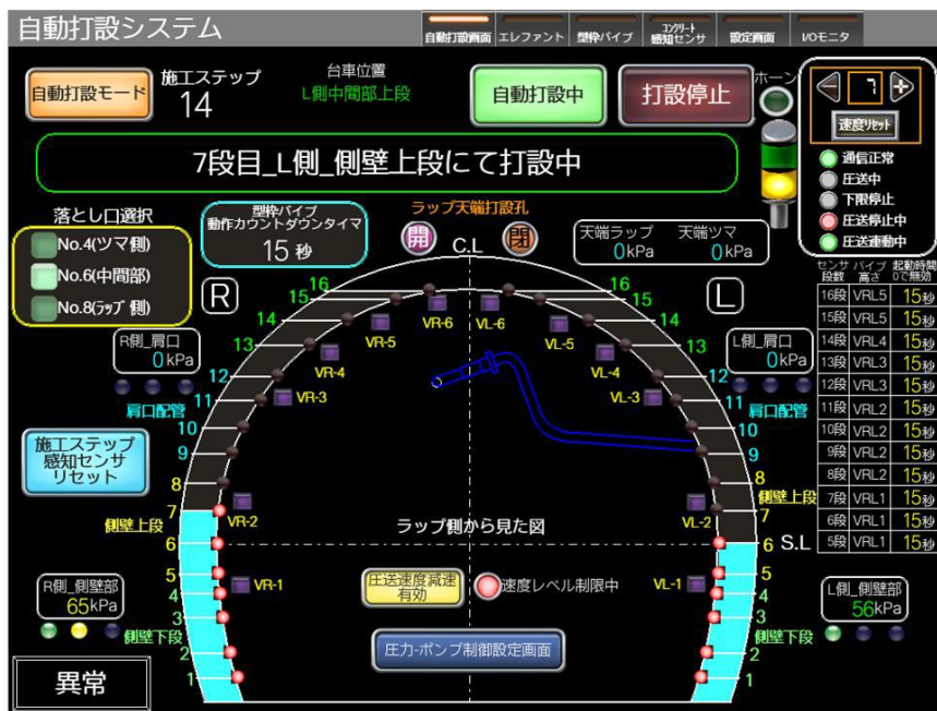
ポンプ圧送速度制御システム
