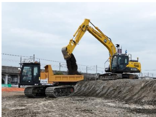
（左）近接したクローラダンプへショベルが自律的に積み込みを行う
