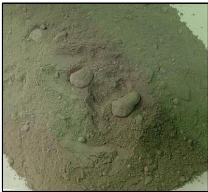
写真① 土質改良材（試作品）
