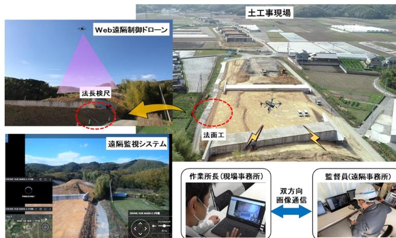
図1 「遠隔臨場ドローンシステム」を使用した遠隔臨場（イメージ）
