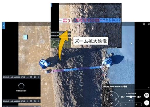
写真2 遠隔臨場で法長検尺
