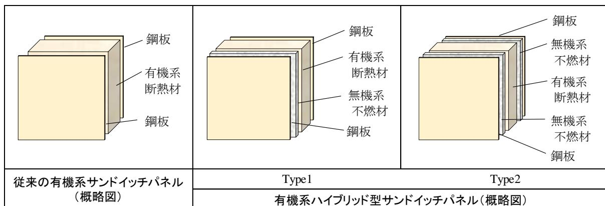
本パネルは、世界中で多発したサンドイッチパネルを用いた建物の火災事故をきっかけに、従来から実施されている防火材料の性能評価試験のコーンカロリーメーター試験（ISO5660 の発熱性試験）において、その性能評価となる基準を満たしました。さらには、新たに建物内装用に区画構成されたサンドイッチパネルの防火性能を評価するために国内で開発された中規模自立型模型箱試験（JIS A 1320）および、冷凍冷蔵倉庫、クリーンルームなどをサンドイッチパネルで構築する際の区画設計技術に関して、延焼拡大防止および倒壊防止性能を評価するための試験として国際標準化機構（ISO）により提案された実大自立型ルームコーナー試験（ISO13784-1）においても、優れた防火性能を有することを確認しました。
