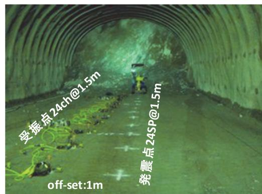
写真4 測線配置状況(発震点オフセット1m)
