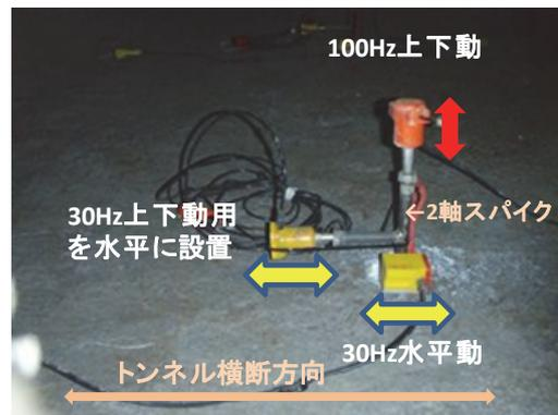
写真3 ジオフォン(受振器)の設置状況
