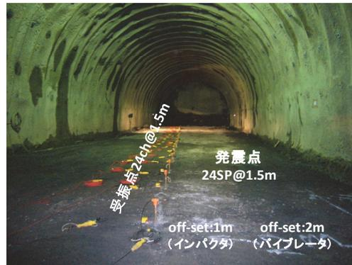
写真7 受振器と測線配置状況(インパクト発震オフセット1m、バイブレータ発震オフセット2m)
