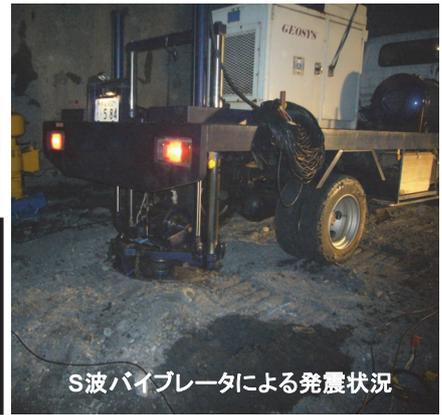
写真6 車載型S波バイブレータの構造と発震状況
