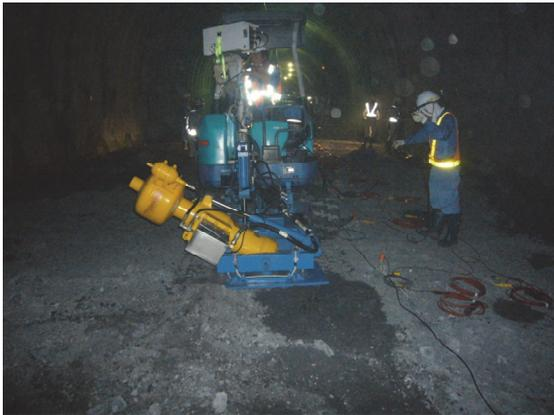
写真5 油圧インパクトによるS波発震(60°片側傾斜)
