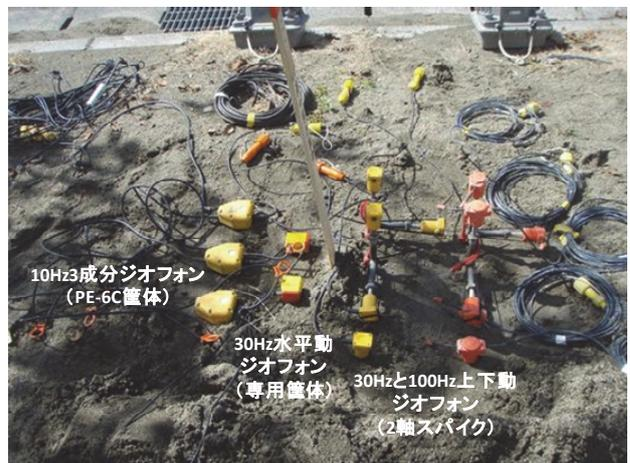
写真8 予備実験で使用した受振装置
